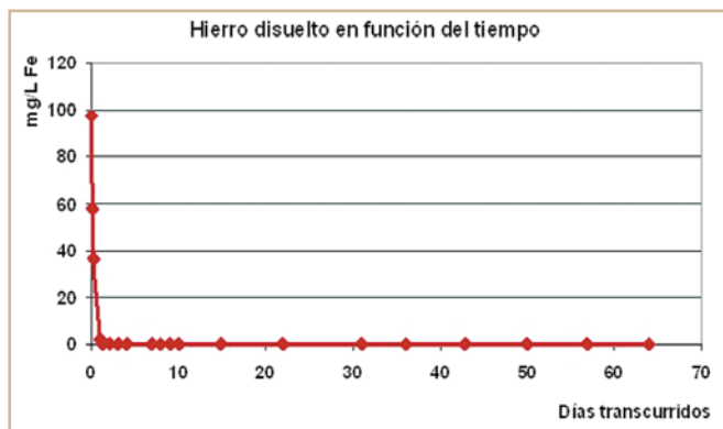
Figura 12. Ensayo in situ de disminución del hierro por efecto de la dolomía de Reocín.
