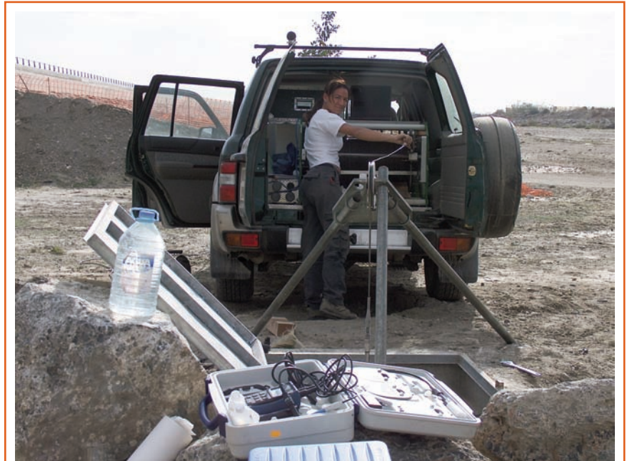
Figura 3a). Testificando el pozo B_320.
