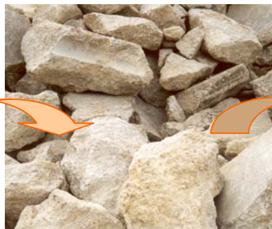
Fotografía 3. Detalle residuos de hormigón
