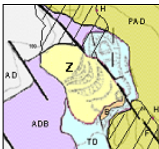
Figura N° 2. Mapa geológico del yacimiento San José-Los Escullos. (Z) Zeolita; (TD) Tobas dacíticas; (AD) Andesitas piroxénicas; (PAD) Andesitas piroxénicas; (B) Bentonita; (ADB) andesita brechosa; (H) Alteración hidrotermal intensa; (F) Fallas.
