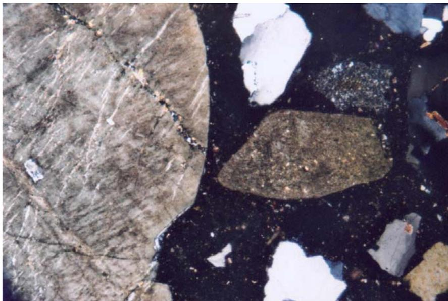
Figura: Fotografía al microscopio de la lámina de árido reciclado - 5
