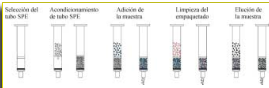
Figura 8. Extracción de compuestos orgánicos disueltos en agua.
