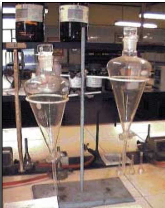
Figura 2. Embudos de decantación para la extracción de muestras de agua.
